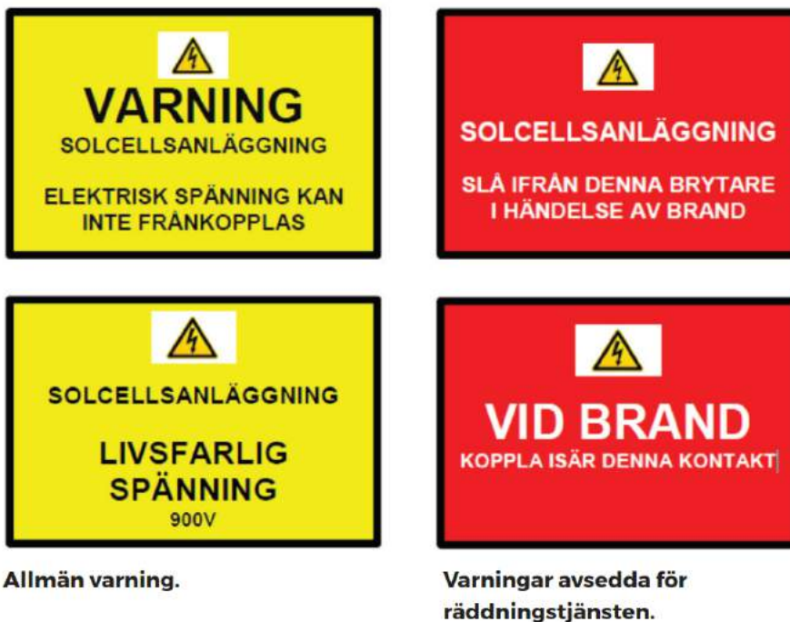
Figur 6. Exempel på varselskyltning för solcellsanläggning.
